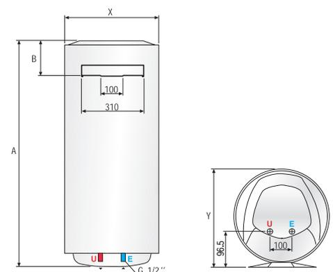
ОБОЗНАЧЕНИЯ V - модель для вертикального монтажа E Вход холодной воды (диаметр резьбы G 1/2")
