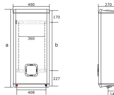
ОБОЗНАЧЕНИЯ **V** - модель для вертикального монтажа **E** Вход холодной воды (диаметр резьбы G 1/2")
